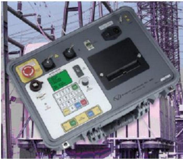
ATRT-03s2 全自动变压器变比测试仪为 VANGUARD 公司第三代基于微处理器控制的变比测试仪，仪器轻便便于携带，测试快捷读数精确，适合于电力企业现场测试各类单、三相电力变压器，互感器。
